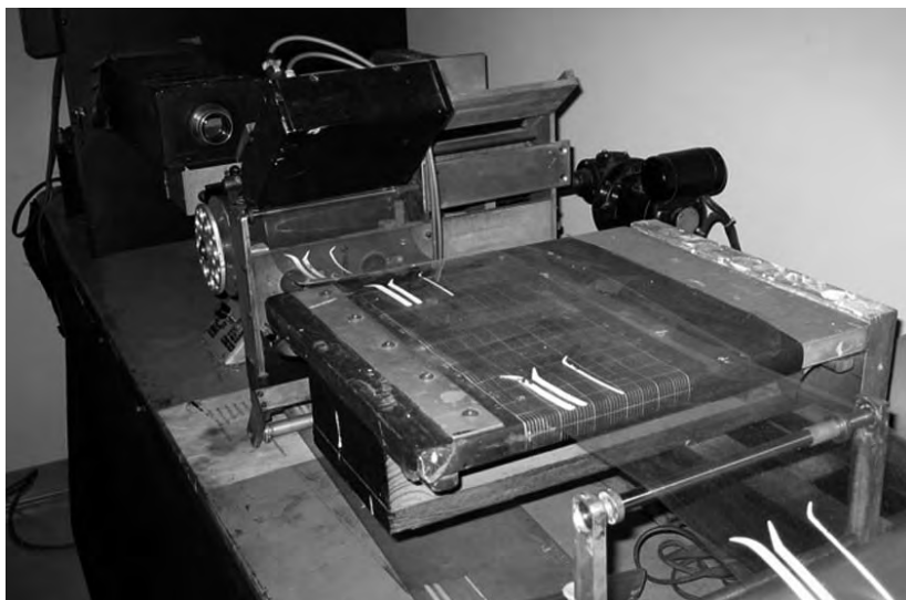
図3 パターンプレイバック装置 (Cooper F.S. in the late 1940s、撮影は筆者)
